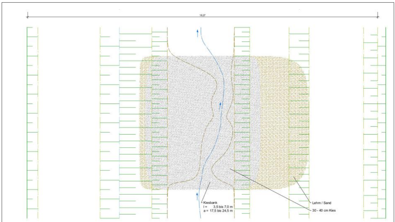
Abb. 18: Regelquerschnitt zum „Wietze-Umbau“ auf Basis des Referenzquerschnitts für die Realisierung der notwendigen Infiltrationsmenge (AGWA, 2023) 73
