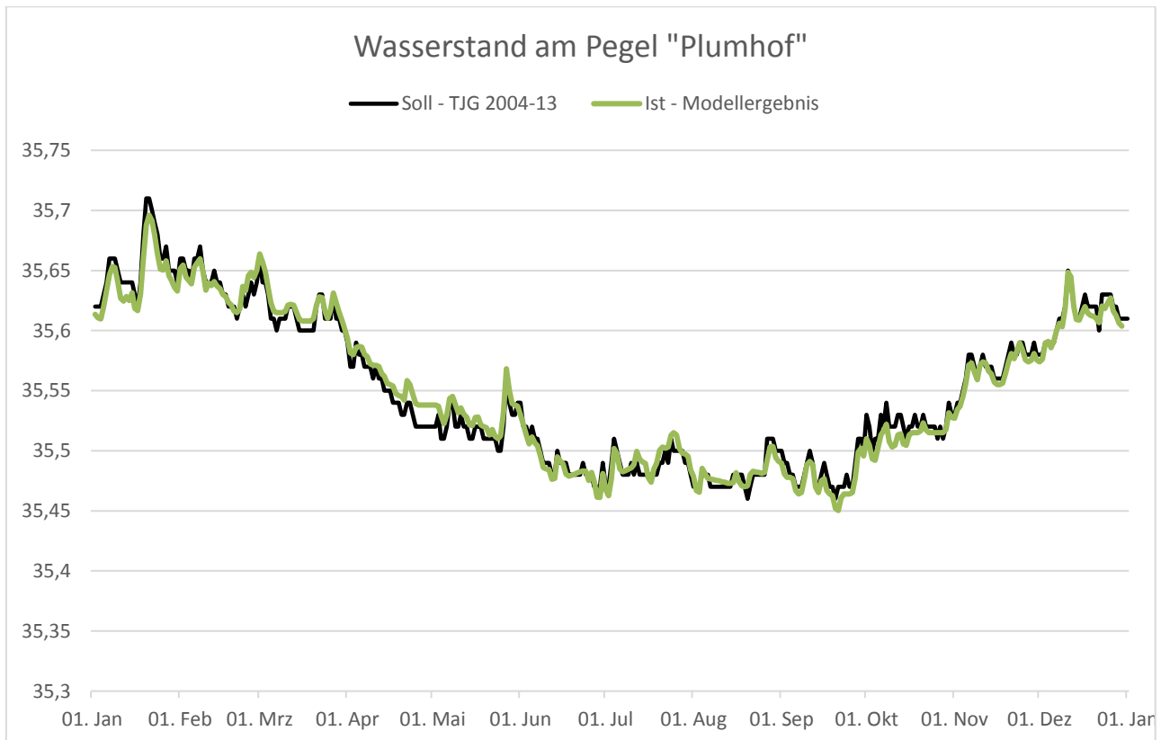
Abbildung 4-5-6: Gemessene und berechnete Wasserstände am Pegel Plumhof
