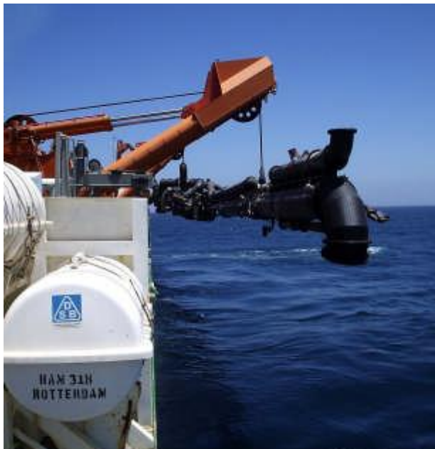
Abbildung 26: Spüldüse (jet nozzles) des Mass Flow Excavators
