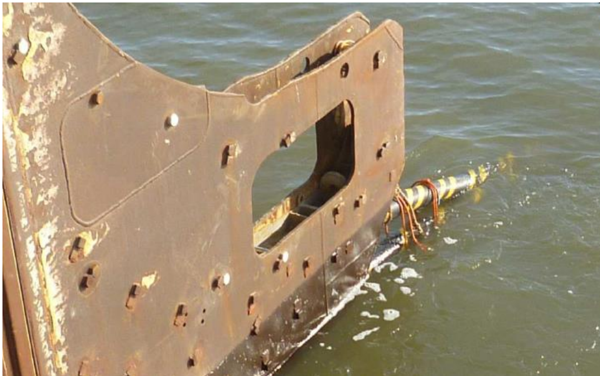
Abbildung 23: Vertical Injector (unterer Teil des stehenden Spülschwerts)
