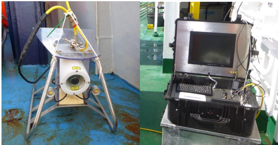
Abb. 3: Für die Videountersuchung genutztes Kamerasystem.
