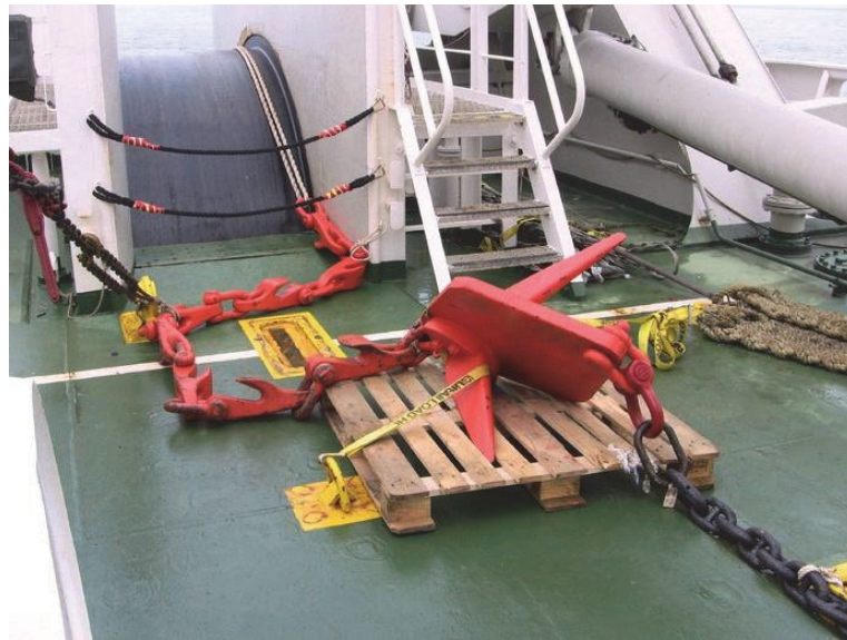
Abbildung 122: Kette mit Suchankern und Drahtcatchern (Quelle: eos projekt)
