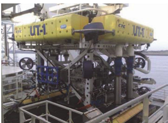
Abbildung(en) 30: Unterwasser-Eingrabegeräte (TROV) (Quelle: CTC).
