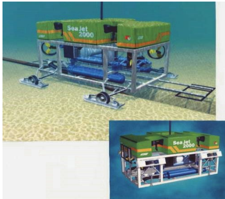
Abbildung 31: Unterwasser-Eingrabegeräte (TROV) (Quelle: OMM).
