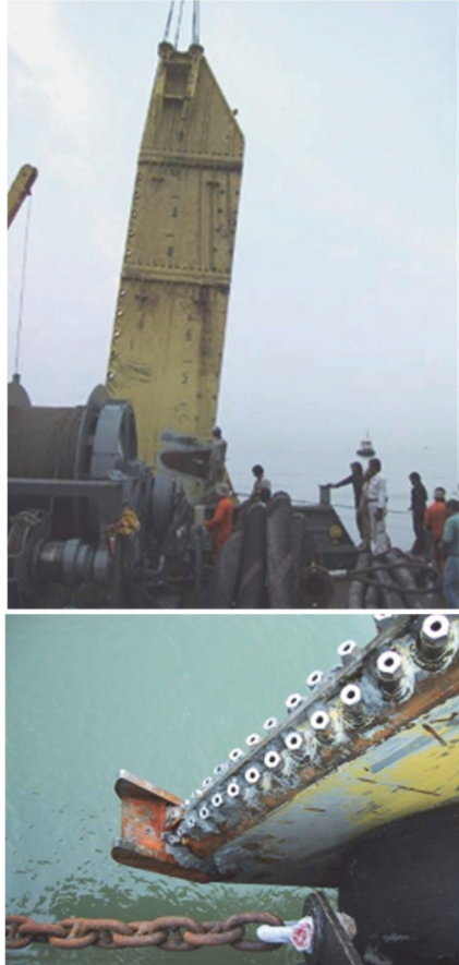
Abbildung 24: Beispiel für ein Spülschwert zum gleichzeitigen Legen und Einspülen (Quelle: Moll-prd).
