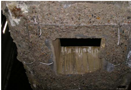
Der Verbund zum Umgebungsbeton ist gewaltig! Der Umgebungs- beton verbindet sich mit CEMflex VB NG so, dass die Schwach- stelle der Beton selbst ist und nicht die Verbindung Beton /CEMflex VB NG!
